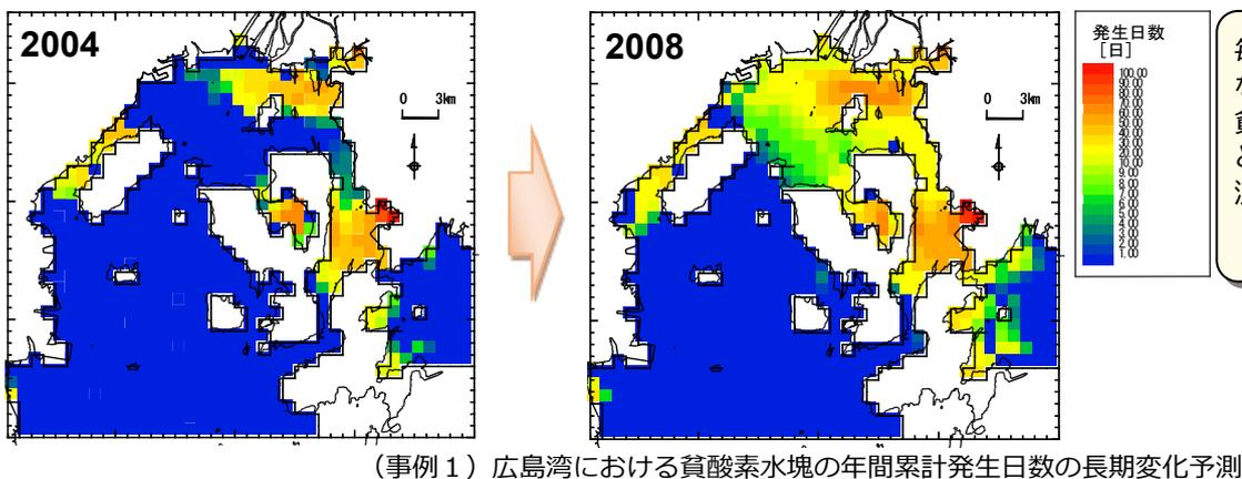
硫化水素などの吸着効果がある石炭灰造粒物を海底に覆砂することで、海底付近の溶存酸素濃度が最大 2mg/L 程度回復すると予測されました。
