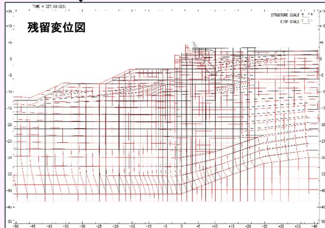
FLIPを用いて既設護岸の変形照査を実施した事例です。地震動（基盤に約400gal）の発生により、護岸背後の埋立土(Fs)や在来砂層(As)が液状化を起こし、それに伴い護岸が2m程度海側に変形することが確認されました。
