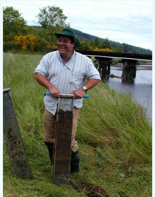
\* ハンディジオスライサーは、地層抜き取り調査法(中田・島崎, 1997、「地盤調査の方法と解説」地盤工学会, 2013)を応用したものです。
