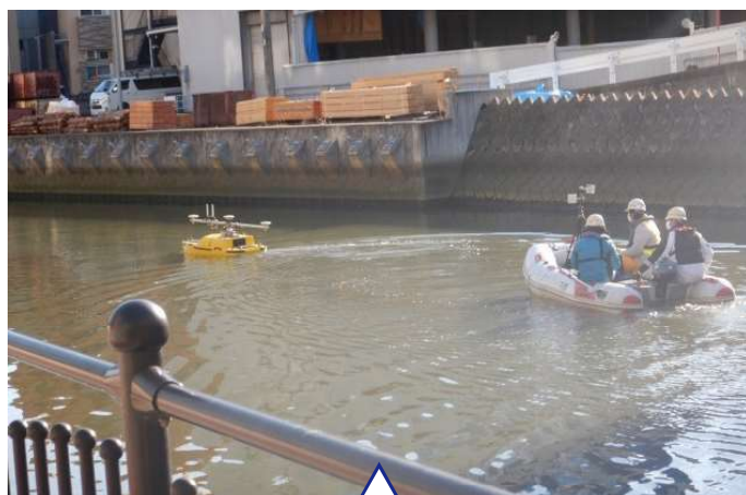
ゴムボートに基地局システムを搭載し、 ラジコンボートを制御。
