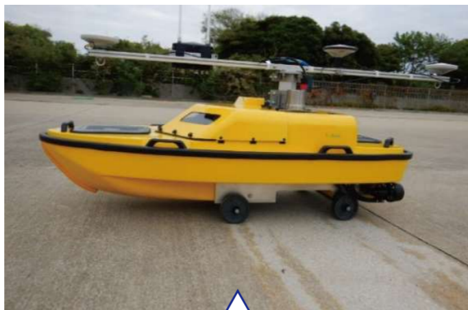
船体にドーリー(タイヤ)を装着しているので、 転がしながら移動が可能。
