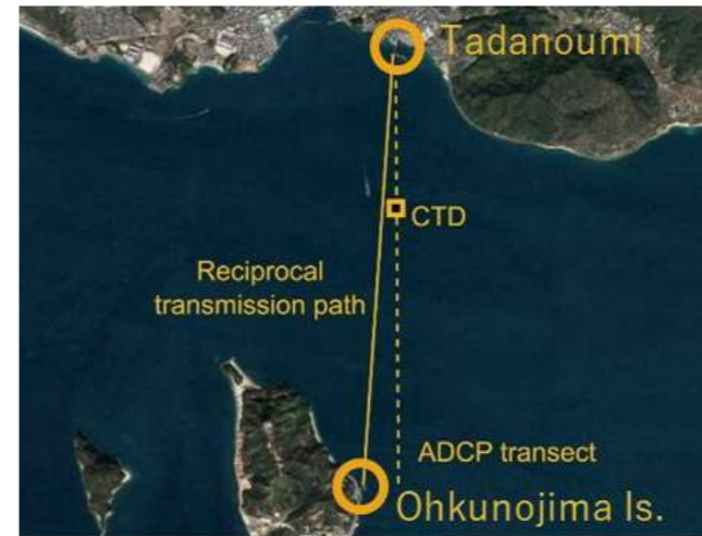
計測事例(広島県忠海沖)の音響局設置位置
