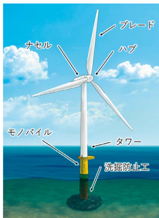
着床式洋上風力発電施設
