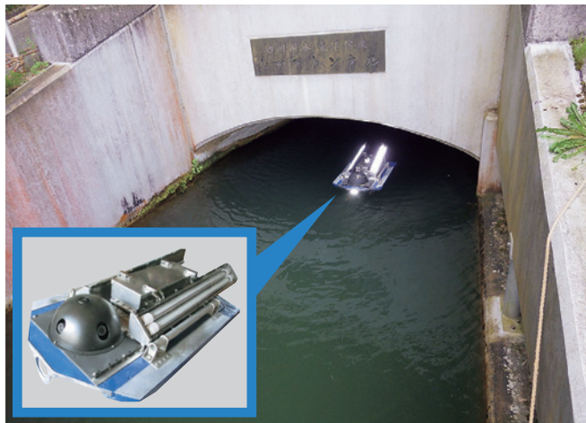
水路トンネル内面調査(調査ロボットによるビデオ撮影、健全度評価)
