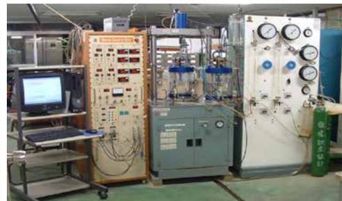
振動(動的・液状化)三軸圧縮試験
