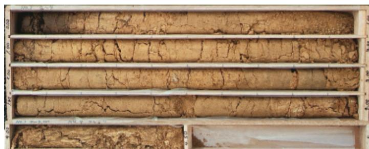
採取された土砂状コア（崖錐堆積物とマサ土）
