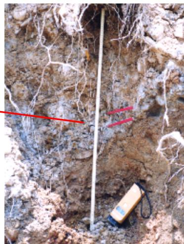
法面崩壊地で出現した地すべり面（上）、地すべり面露頭での帯磁率測定（右）
