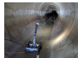
有線水中移動式カメラによる下水管調査
