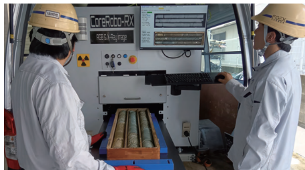
「コアロボ」によるボーリングコアの撮影状況
