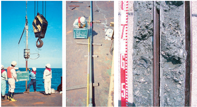
作業状況 試料採取パイプ 採取された海底堆積物連続試料
