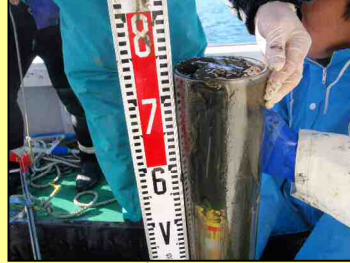
アクリルパイプを用いて、海底泥をそのままの状態にて採取
