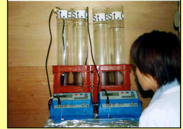
採取した海底泥を実験室に持ち帰り、海底泥が酸素を消費する速度を測定
